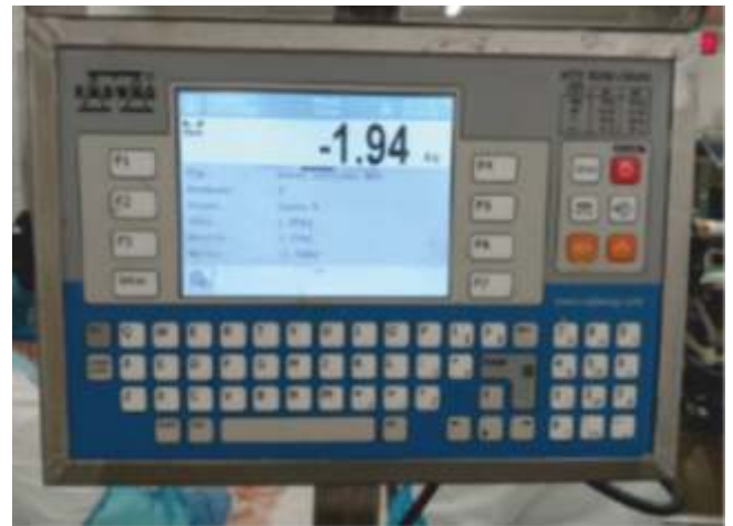
Терминал станции взвешивания (клавиатурный терминал HY, на 2017 г. вместо него выпускается модель HY10)
