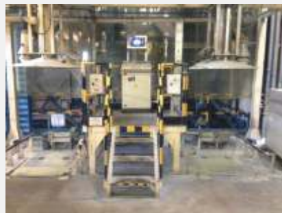
Терминал контроля дозирования, подключенный к ПЛК по интерфейсу RS-232
