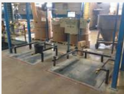
Терминал PUE 5, управляющий дозированием по состоянию входов/выходов
