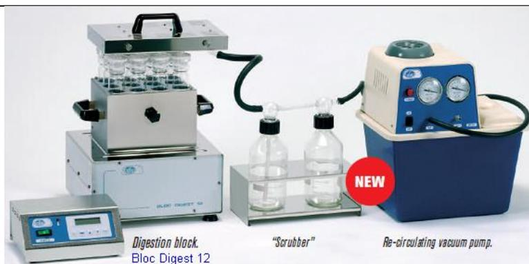
На рис. показана система Bloc Digest 12 со скруббером
