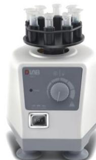
Вортекс с функцией разрушения клеточной стенки. Принцип разрушения клеток состоит в том, чтобы полностью перемешать суспензию клеток и микрогранулы при быстром встряхивании; микрогранулы и клетки сдвигаются и сталкиваются друг с другом, способствуя фрагментации клеточной стенки и высвобождая содержимое, тем самым достигая эффекта фрагментации клеток.
