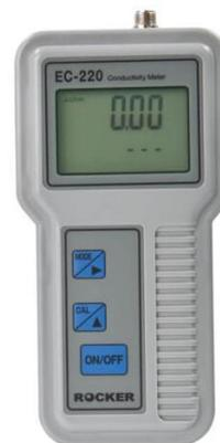
Компактный анализатор жидкости EC220 предназначен для проведения быстрых анализов «на месте». Его можно использовать для измерения проводимости бытовой, технической воды, воды для аквариума или для бассейна. Значения высвечиваются на двухстрочном ЖК-экране. Прибор выполнен во влагозащищенном корпусе с защитой IP65, не боится случайных брызг. Работает прибор от источника питания постоянного тока 9В.
